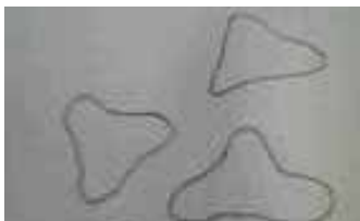
(a) 縦糸断面拡大図
