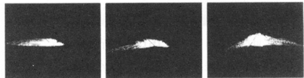
(a) 横糸方向から入射 (b) 45° 方向から入射 (c) 縦糸方向から入射 図 9: 反射光の実測値
